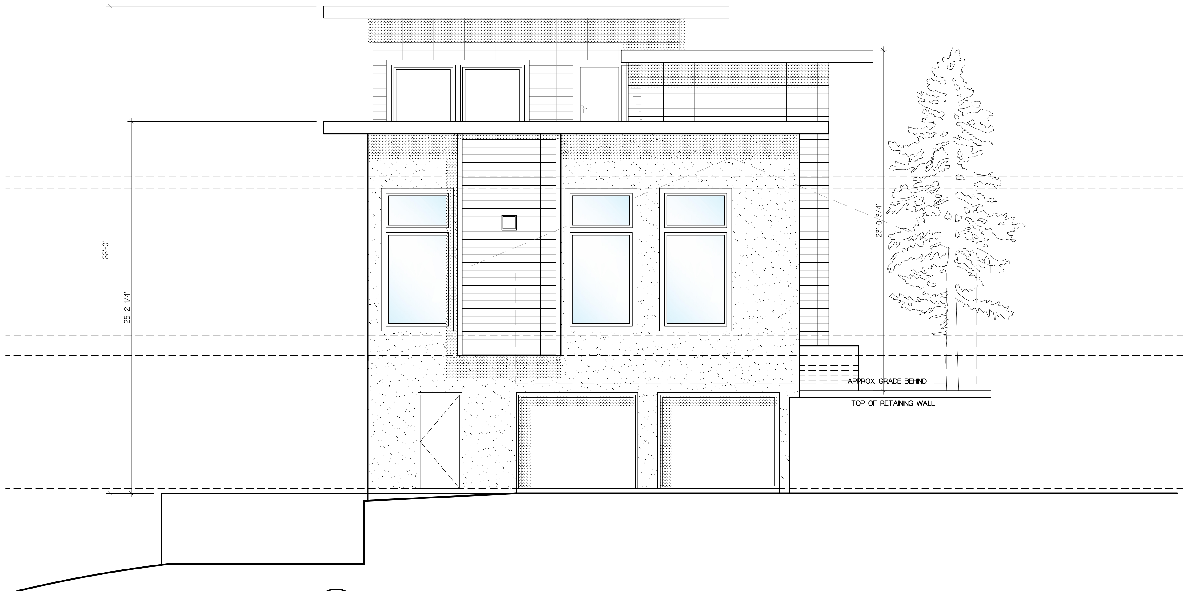
2 LEFT-SIDE ELEVATION SCALE: 1/4"=1'-0"
